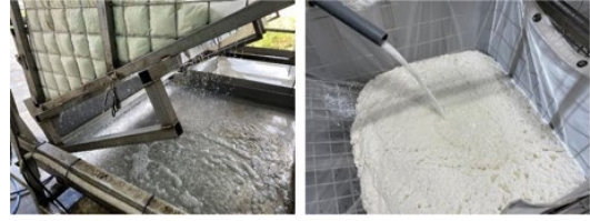
図3. 現地に設置した処理装置 （左：処理液、右：濾布による分離）
